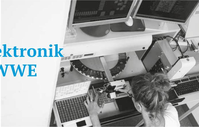
Für die Prototypenentwicklung und Fertigung elektronischer Geräte in kleinen Stückzahlen besteht in der WWE die Möglichkeit zur Bestückung von Leiterplatten. Mithilfe des halbautomatischen Bestückungssystems verbaut Sandra Büglmeier hier gerade Bauteile, die kleiner sind als ein Kubikmillimeter. Die optische Kontrolle erfolgt über die Computermonitore am oberen Bildrand.
