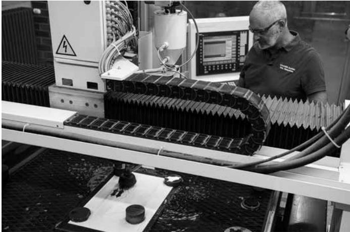
Die Hochdruck-Wasserstrahl-schneidanlage der WWM ermöglicht die umweltfreundliche und hochpräzise Schnittbearbeitung fast aller Materialien – ohne Erhitzung oder Verformung. Metallbauer Ralf Honz überwacht hier gerade die Herstellung eines „Ameisenlabyrinths“ aus Kunststoff für die Verhaltensforschung.
