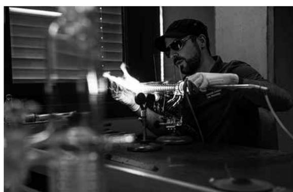
Christian Müller, der Glastechniker der WWM, erhitzt mit dem Gasbrenner Stäbe, Kolben und andere Glaselemente bis zum Schmelzpunkt, um sie auf Kundenwunsch zu modellieren oder zu verschmelzen. Im Bild wird gerade die Schlifverbindung eines Intensivkühlers, ein Gerät aus dem Chemielabor zur Kondensation von Gasen und Dämpfen, angeschmolzen.
