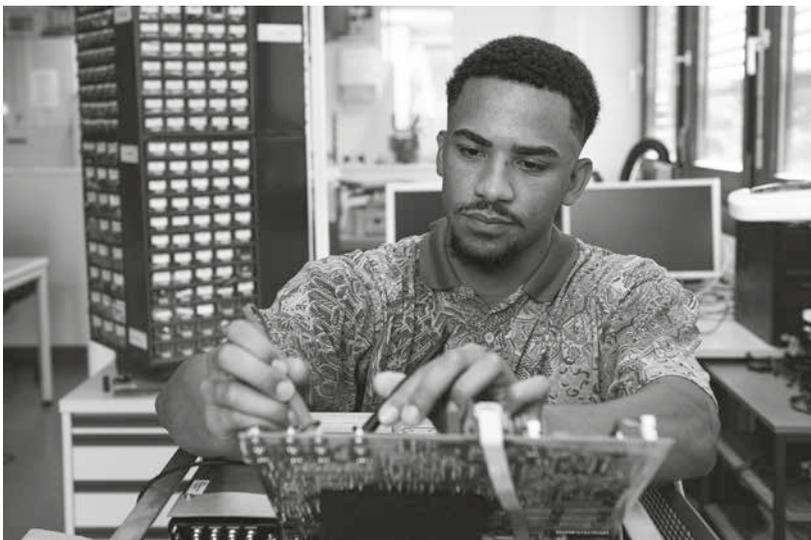
Das Serviceangebot der Wissenschaftlichen Werkstätten beinhaltet auch die Reparatur von elektronischen Kleingeräten. Im Zuge einer Fehleranalyse misst Marcel Geist, Elektroniker-Auszubildender in der WWE, gerade verschiedene elektrische Kenngrößen eines geöffneten, defekten Laborgeräts.
